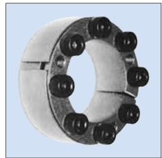
Welle und Nabe anliegen. Durch Umlenken der axialen Schraubkräfte entsteht auf den Berührungsflächen an Welle und Nabe Pressung. Diese Kräfte und Welle  $(P_w)$  und Nabe  $(P_N)$  bewirken einen Haftwiderstand, mit dem sowohl radiale als auch axiale Kräfte übertragen werden. Die Größe der Kraft ist von dem Anzugsmoment (Md) jeder Schraube und dem Winkel (B) abhängig.
