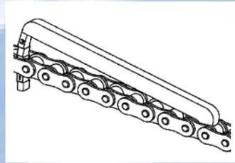
Am beschrifteten Arm kann die Kettenverlängerung abgelesen werden. Auf dem Bild ist eine Verlängerung von 2% zu erkennen.
