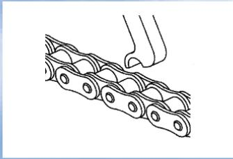
Verschleißlineal auf eine Rolle setzen.
