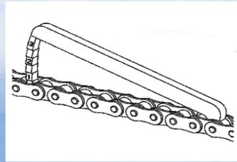
Das andere Ende durch drehen um die Rolle in die Kette einführen.
