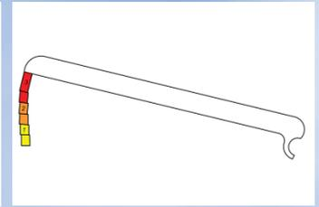
Die Zahlen auf dem Messinstrument zeigen die Kettenverlängerung in Prozent an. Passt die Abstufung mit der entsprechenden Zahl zwischen zwei Rollen, so ist eben diese Verlängerung erreicht. Es ist eine Abstufung von 0,5% messbar. Die erste Abstufung misst eine Verlängerung von 0,5%
